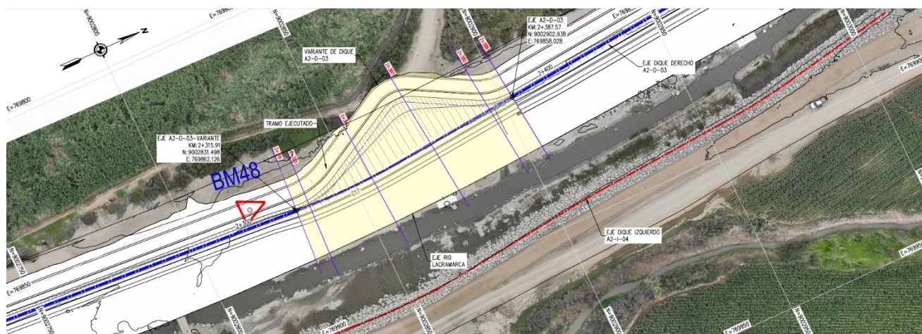
Imagen 12 Dique a intervenir en Baden Pk 14+890
