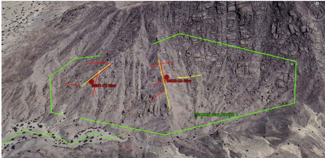
Figura N° 22. Distribución de ensayos indirectos: Refracción sísmica (línea amarilla), MASW2D (línea roja) y perforación diamantina (puntos rojos). Cantera San Bartolo 1 - Chicama
