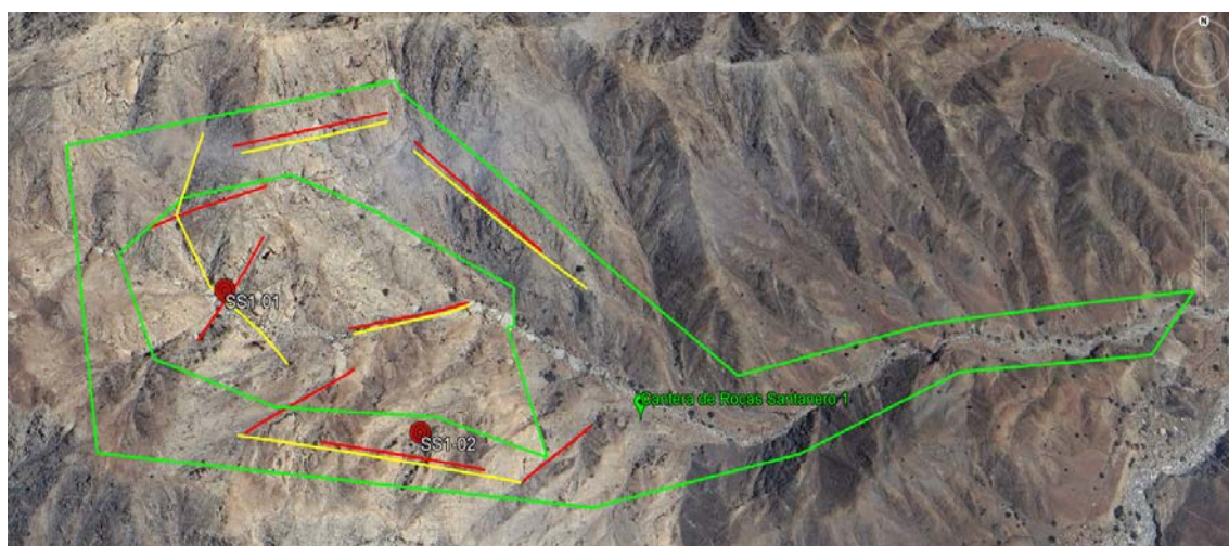
Figura N° 29. Distribución de ensayos indirectos: Refracción sísmica (línea amarilla), MASW2D (línea roja) y perforación diamantina (puntos rojos). Cantera Santanero 1 - Chicama
