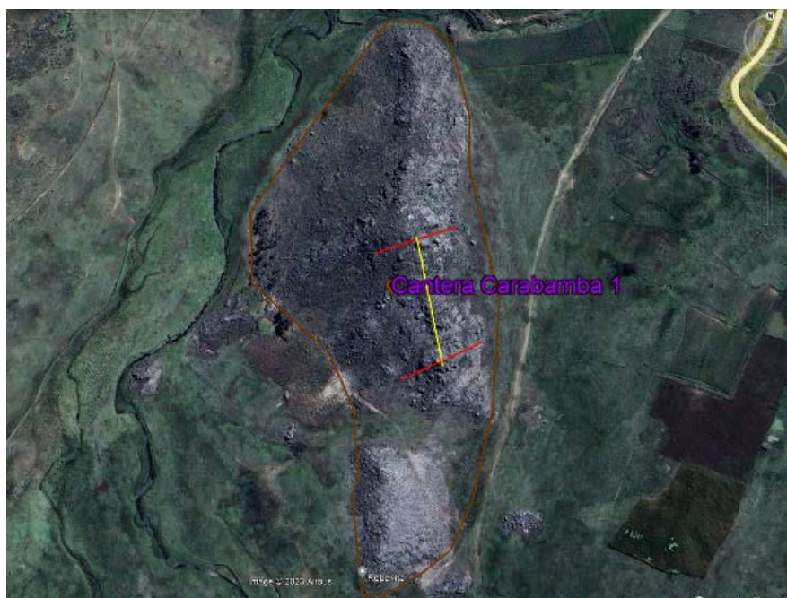
Figura N° 10. Distribución de ensayos indirectos: Refracción sísmica (línea amarilla), MASW2D (línea roja). Cantera Carabamba 1 - Virú
