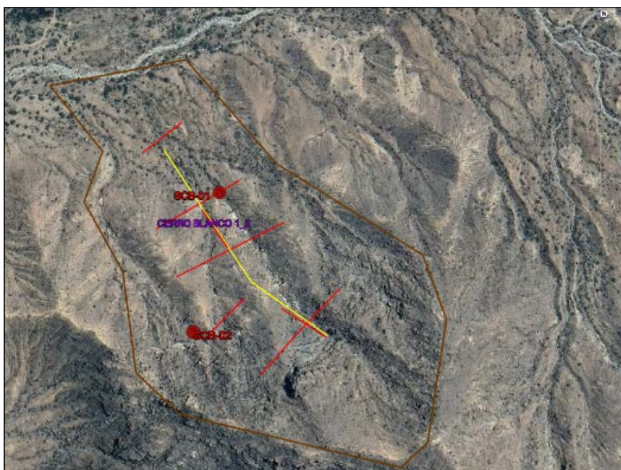
Figura N° 7. Distribución de ensayos indirectos: Refracción sísmica (línea amarilla), MASW2D (línea roja) y ensayos directos (puntos rojos). Cerro Blanco 1-2.
